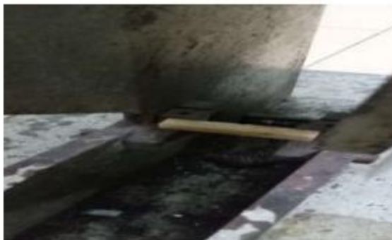
Gambar 3 Proses pengujian spesimen impact
