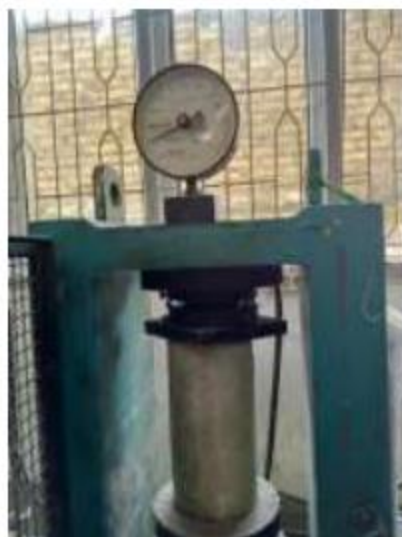
Gambar 4 Pengujian Kuat Tekan Beton
