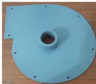
Gambar 10 Penyusutan Ukuran Casing Blower
