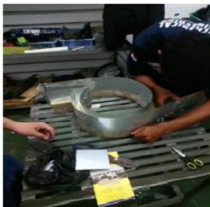
Gambar 7 Melepaskan resin dari cetaka
