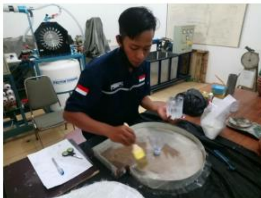
Gambar 4 Melapisi permukaan cetakan
