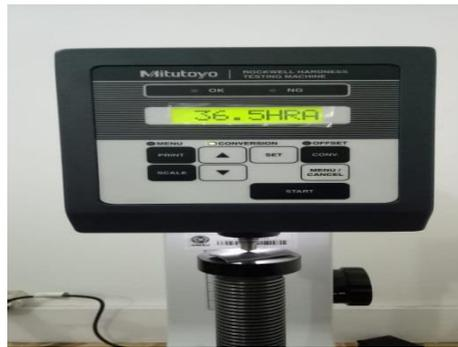
Gambar 4.1 Pengujian pertama pada bahan pengecoran
