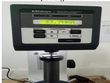
Gambar 4.2 Pengujian kedua pada bahan pengecoran
