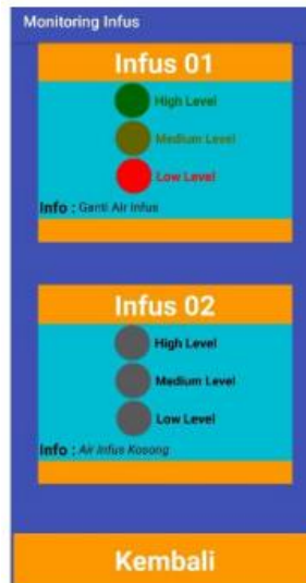
Gambar 3. Kondisi Cairan Infus Pada Posisi Low Level
