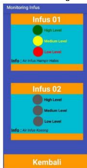
Gambar 2. Kondisi Cairan Infus Pada Posisi Medium Level
