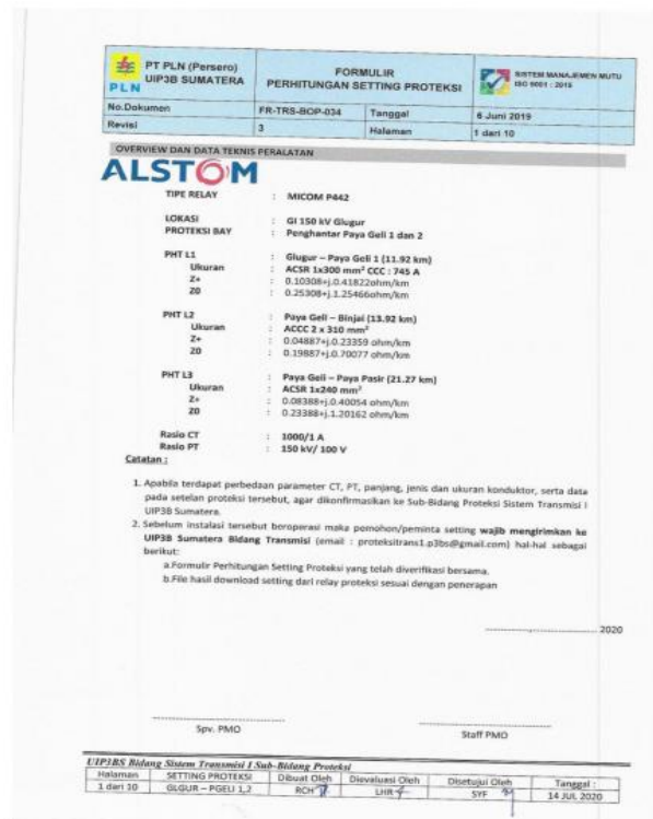
Gambar 1 Data Teknis Peralatan GI Glugur – GI Paya Geli
