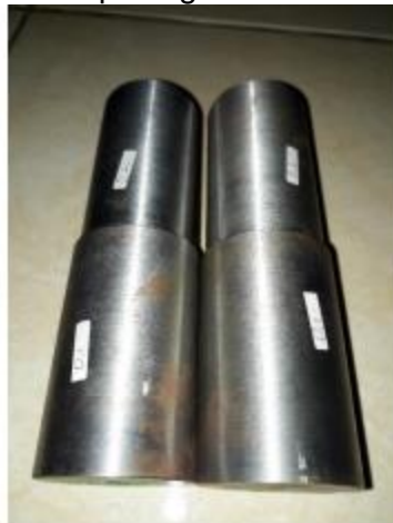
Gambar 2 Hasil pembubutan spesimen Baja ST 37
