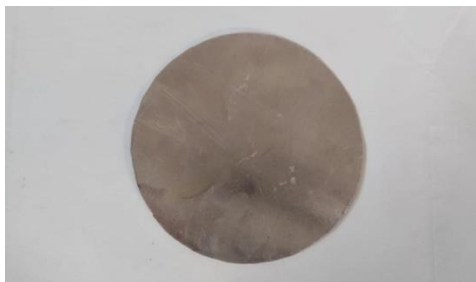
Gambar 3.12 Spesimen Uji Tekan
