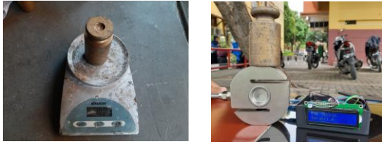
Gambar 4.3 Kalibrasi Menggunakan Timbangan Analog
