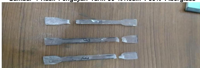
Gambar 5 Hasil Pengujian Tarik 75 % Resin : 25 % Fiberglass
