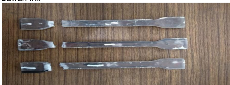
Gambar 3 Hasil Pengujian Tarik 70 % Resin : 30 % Fiberglass
