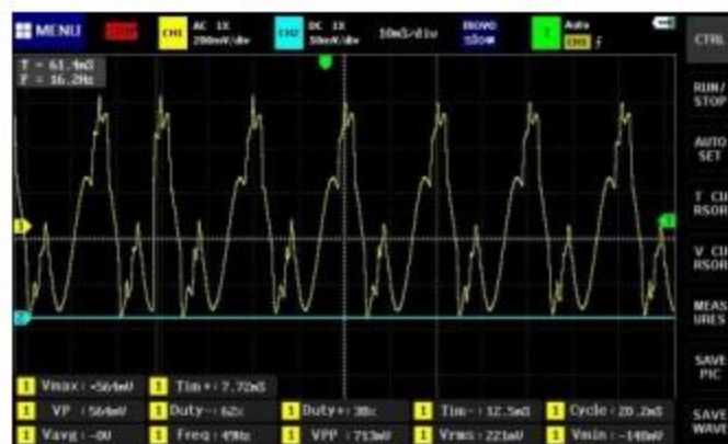
Gambar 5. Hasil Gelombang saat menggunakan Kapsitor 47 nF
