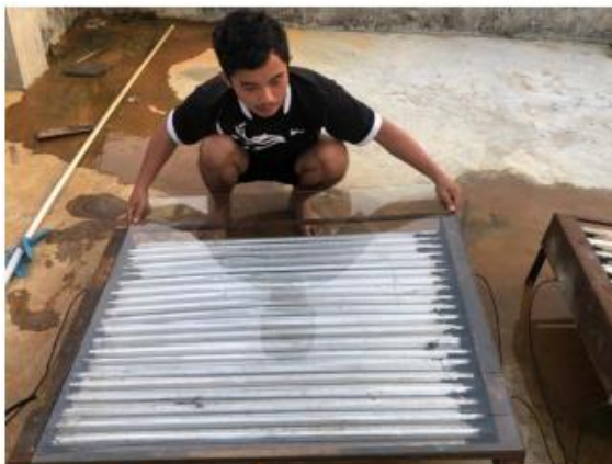
Gambar 11 Pemasangan Kaca Penutup
