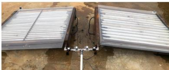
Gambar 2 Hasil Pembuatan Solar Water Heater Double Slope
