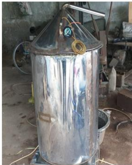
Gambar 3 Hasil dari pembuatan tabung ketel pada alat penyulingan minyak atsiri
